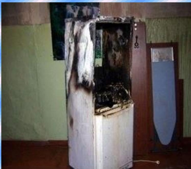
Достаточно перегрева, небольшого замыкания, и скопившаяся за холодильником и на его задней панели пыль очень хорошо распространяет пламя. Огонь также могут поддержать висящие рядом шторы и полотенца.
